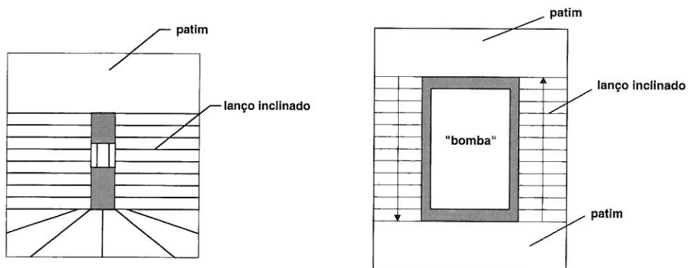
a) Caixa de escada sem "bomba"
